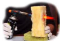
По теплохарактеристикам материалы практически одинаковы. Температура горения (плавления) базальтовой ваты 1200 °С, стекловаты — 450 °С. Оба материала не поддерживают огонь и при прямом воздействии огня только плавятся.
